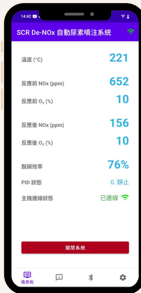
挖土機啟動後，尿素開始注入
