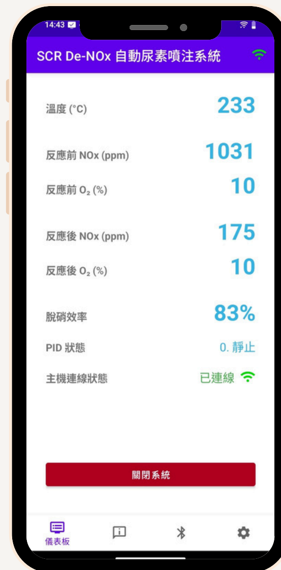
高負載狀態下，溫度升高 持續注入尿素水，脫硝效率達83%
