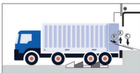
4.裝卸完畢，安全撤出貨車車廂
