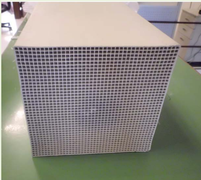
(堇青石材質蜂巢式 SCR 觸媒)
